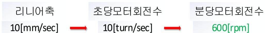
리니어모터가 초당 10[mm]를 이동하려면 모터가 초당 10[turn]으로 회전해야 합니다. 모터가 초당 10[turn]으로 회전하려면 분당 회전수는 600[rpm]이 되어야 합니다.
